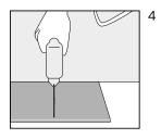
Отметьте, где должна быть разрезана доска, поместите ее на рабочую поверхность и разрежьте по размеру с помощью любой пилы.
