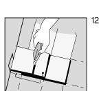
Последнюю и первую планку необходимо разрезать на необходимую ширину. Поместите последнюю планку сверху предпоследней планки. Разметьте планку с помощью куска планки, не фиксируя полосу. Оставьте расстояние 5 мм до стены для расширительного зазора.
