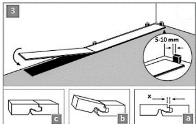
3. С помощью ножа и угольника отрезать последнюю доску ряда такого размера, чтобы между концом ряда и стеной остался 8-мм зазор.
